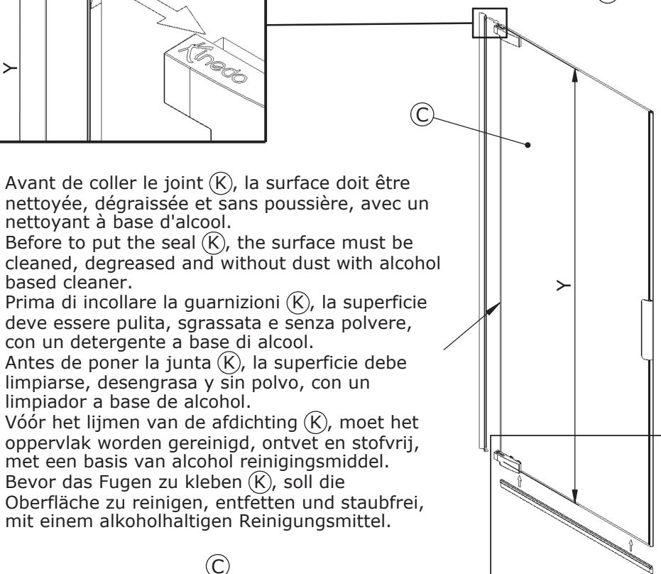
Avant de coller le joint **K**, la surface doit être nettoyée, dégraissée et sans poussière, avec un nettoyant à base d'alcool.
