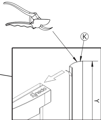
Avant de coller le joint (K), la surface doit être nettoyée, dégraissée et sans poussière, avec un nettoyant à base d'alcool.
