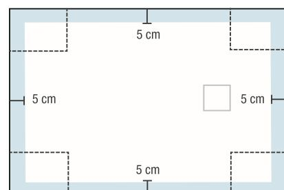
Maximaal zaagbaar oppervlak (bij niet volledige inbouw dienen de gezaagde zijden tegen een muur gepositioneerd te worden)
