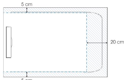
Maximaal zaagbaar oppervlak (bij niet volledige inbouw dienen de gezaagde zijden tegen een muur geplaatst te worden)
